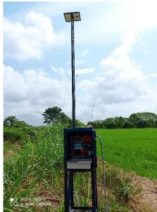
Receptor, Panel Solar, Batería, regulador de voltaje y antena emisora de información
