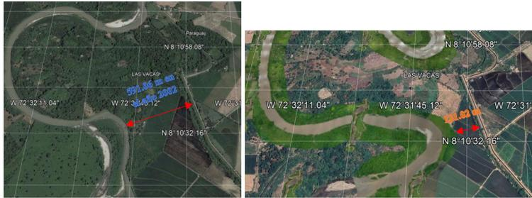
Sector Los Reyes: en esta área el río Zulia tiene la tendencia a direccionar sus aguas hacia su margen derecha, con lo cual esta cambiando su cauce, y está muy próximo a arrasar con el canal de riego SJ-17, en esta zona se han presentado afectaciones de cultivos de arroz con el desbordamiento de las aguas de este río.
